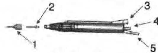
Figura 5.3. Aguja y mango de ultrasonidos. 1. Muestro de la aguja 2. Aguja 3. Puerto de irrigación 4. Puerto de aspiración 5. Cable de ultrasonido.
